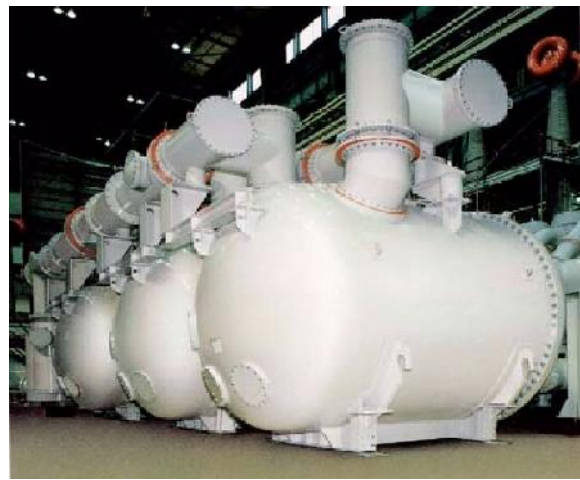
b) High Pressure GIT 275kV-300MV
